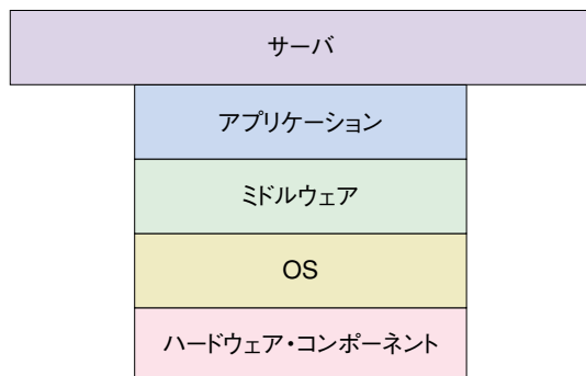
図3 コンピュータを論理的なレイヤ構造に分割して考える場合、仮想化はそれぞれのレイヤごとに異なる技術を用いて行なわれている。必ずしも、複数台のサーバを巨大コンピュータ・プールにまとめ上げる技術だけがサーバの仮想化化なのではない。
